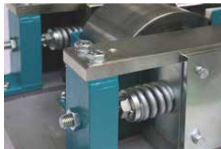
Пружинный блок регулировки усилия
