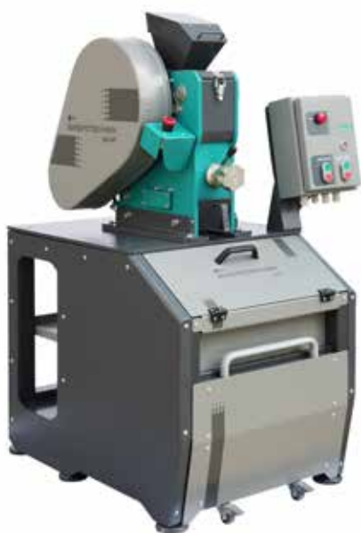
Дробильно-сократительный агрегат на базе ЩД 6М
