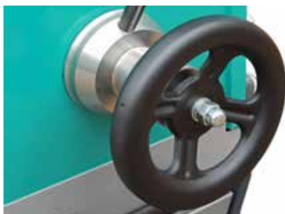
Устройство регулировки зазора между щеками ЩД 15
