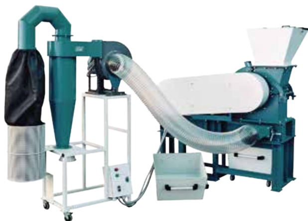
Дробилка молотковая МД 5х2 с БПУ , опорной рамой, МПУЗ и двумя приемными емкостями объемом 50 л.
