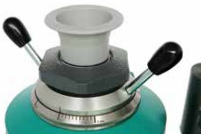
Устройство регулировки зазора между дисками
