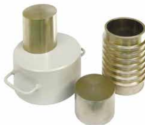
Форма, верхний и нижний пуансоны, а также пригруз для формы Ø71,4 мм
