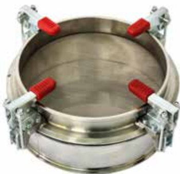
Сито C 20P с полиамидной сеткой на поддоне Ø200 мм
