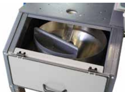
Пробоприемник с лотком на 25%
