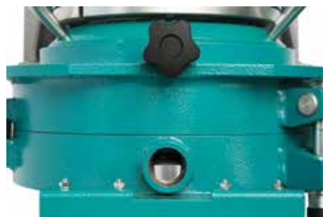
Отверстие для контроля зазора между дисками
