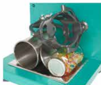
Чаши Смесителя С 2.0 «Турбула» из нержавеющей стали и стекла
