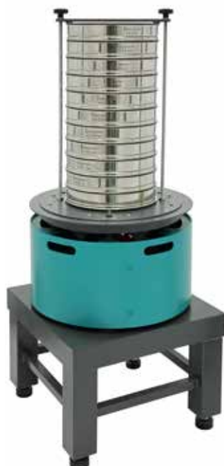
Анализатор A 30 на базе ВП 50 на тумбе Т 40
