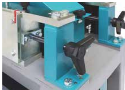
Устройство регулировки подвижного валка
