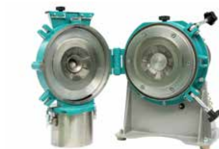
ИД 175М с открытой откидной камерой
